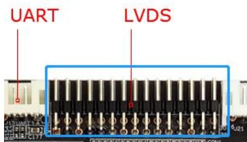
通用的LVDS 接口定义，支持单/双，6/8/10 位1080P LVDS 屏。屏电压可以通过跳线帽进行选择，可选择支持3.3V/5V/12V 屏电源供电。
