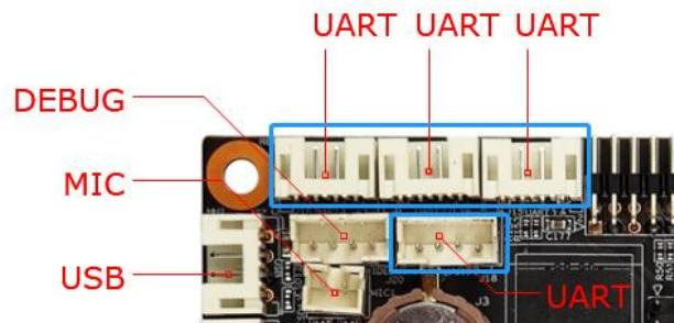
板卡引出了两组普通UART串口，可支持市面上通用的UART串口设备。
